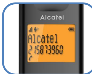
Pantalla retroiluminada de fácil lectura de 2 líneas.
